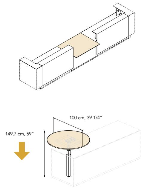
**piano conversazione con colonna elettrica**, conversation top with height-adjustable column, plan conversation latéral avec colonne électrique, platte für Gesprächstisch mit elektrische Säule, conferentiebladen met elektrische kolum, plano de conversación con columna eléctrica
